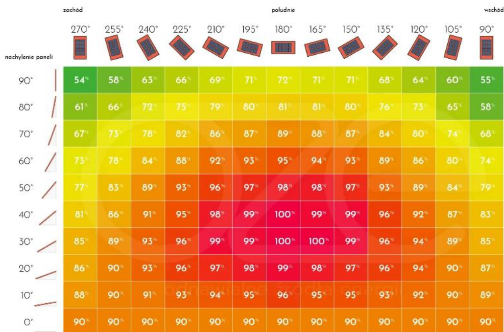
Rys. 1. Wydajność paneli fotowoltaicznych pod względem kąta nachylenia paneli w Polsce ( https://oze.net.pl/ )
